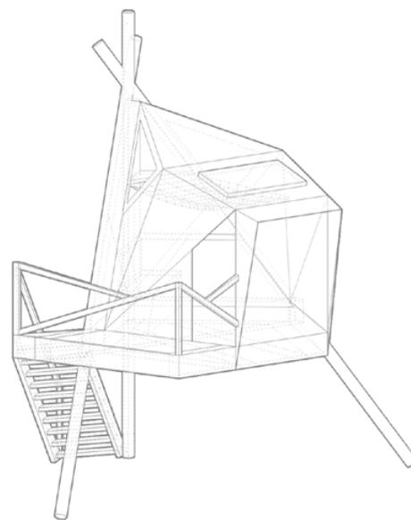
**Pilotis avec Balcon :** Kujuk levé à 7 pieds dans les airs avec un accès par escalier :
